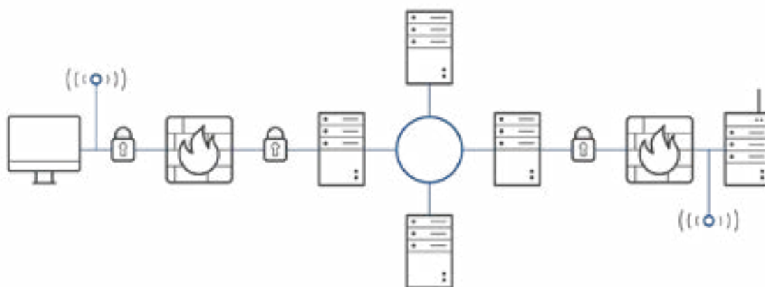
Figura 2 – L'architettura Exor combina dispositivi IoT sviluppati secondo un processo certificato ISA/IEC 62443-4-1 e la piattaforma cloud Corvina, gestita in un sistema di gestione certificato ISO/IEC 27001 che include il ciclo di vita di sviluppo sicuro. L'approccio Secure by Design attraversa l'intera catena, dal dispositivo al cloud, con accesso remoto sicuro e latenza controllata.
